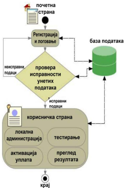
Слика 3. Блок шема система за on-line процену квалитета слуха
